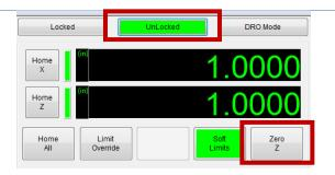
FIGURE 7 - ZERO THE AXES
