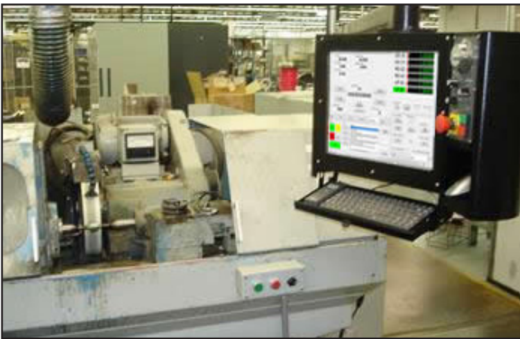
OD Grinder CNC Retrofit MachMotion
