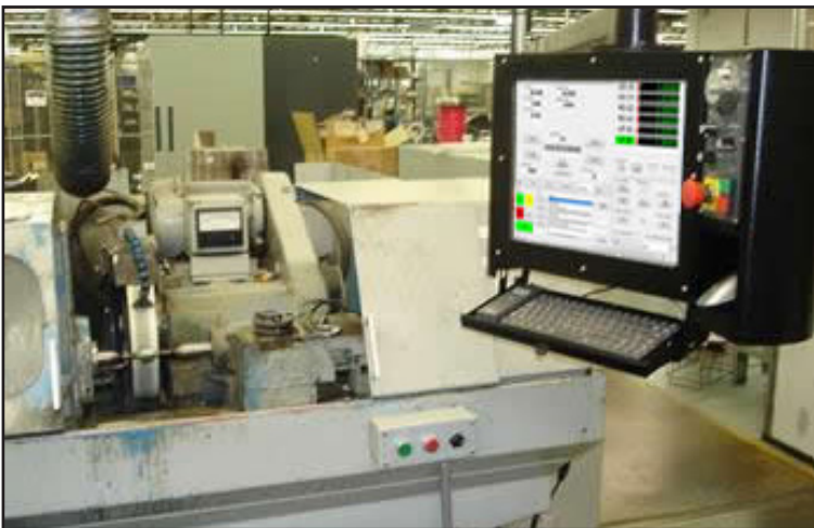
OD Grinder CNC Retrofit MachMotion
