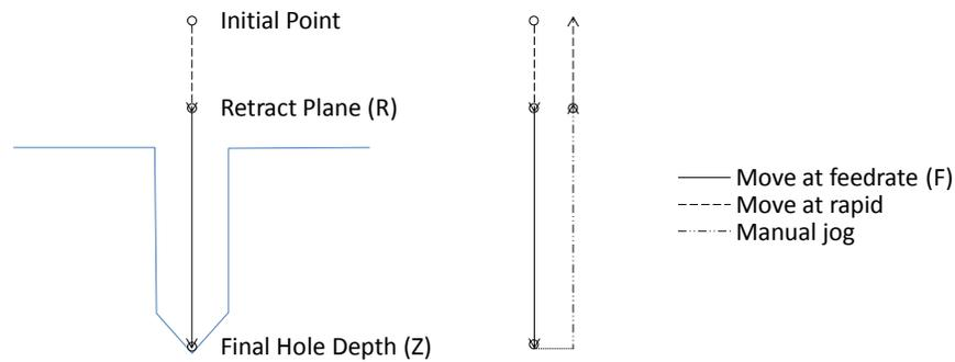
FIGURE 26 MOTION OF TOOL POINT FOR G85 CYCLE
